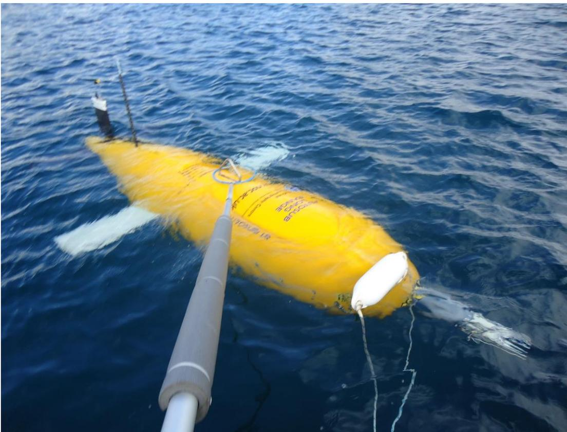
*Figura 13. Vehículo submarino no tripulado – Autosub - NOC*
