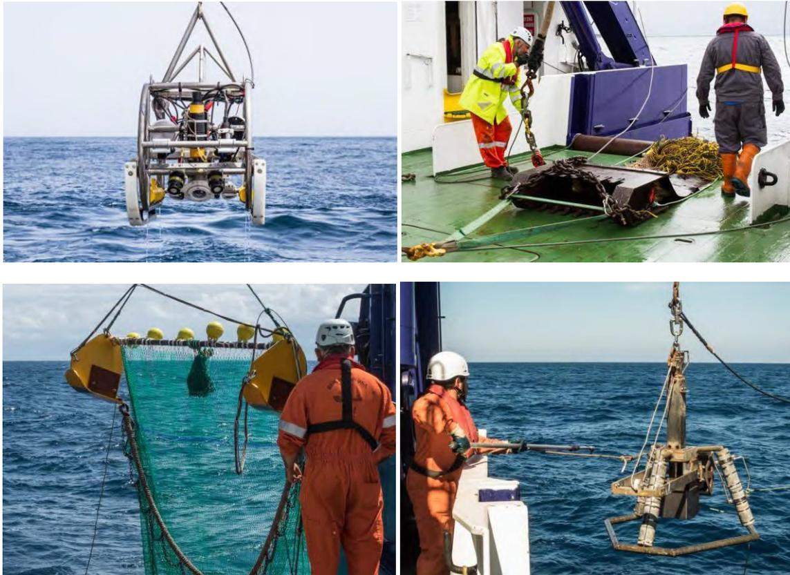
Ilustración 1. Muestreadores utilizados en la Campaña CANVIS 2018 (de arriba abajo y de izquierda a derecha): trineo fotogramétrico, draga de roca, patín epibentónico y box-corer.
