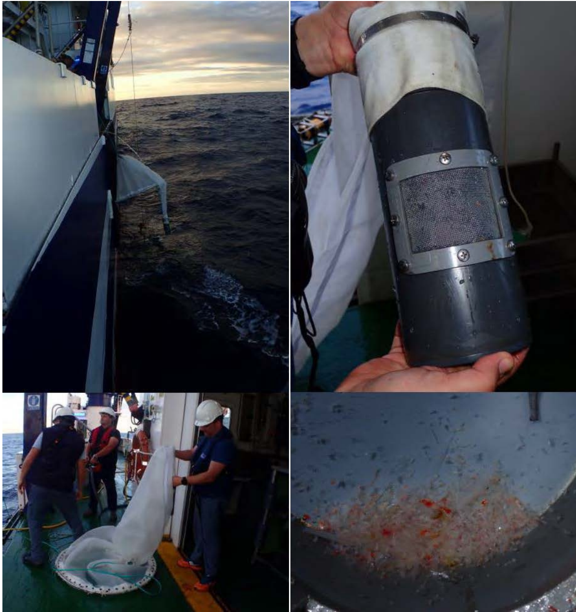
Ilustración 5. Red de plancton WP2: maniobra y detalles de accesorios.
