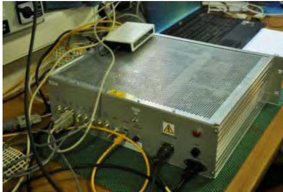
Unidad de cubierta del multiplexor NEXUS
