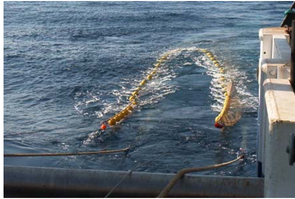
Figura 11. Arte de arrastre con puertas experimental GOC-73 utilizado durante la campaña INTEMARES-A22B-1019 para la toma de muestras de fauna necto-bentónica y recursos demersales en fondos sedimentarios.
