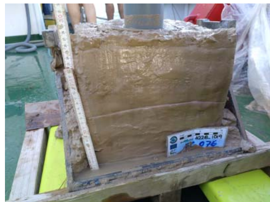
Figura 8. Draga Box-Corer (izquierda) utilizada durante la campaña INTEMARES-A22B-1019 para la toma de muestras estratificadas de sedimentos (derecha) de la superficie del fondo marino.
