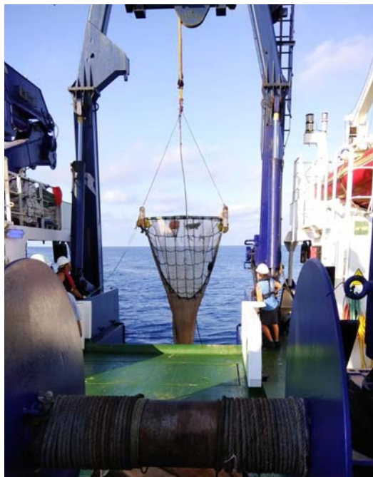
Figura 10. Patín epi-bentónico utilizado durante la campaña INTEMARES-A22B-1019 para la toma de muestras de flora y fauna bentónica en fondos sedimentarios.
