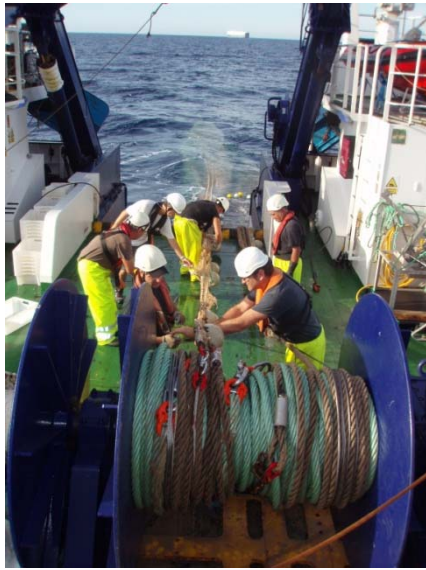
Figura 11. Arte de arrastre con puertas experimental GOC-73 utilizado durante la campaña INTEMARES-A22B-1019 para la toma de muestras de fauna necto-bentónica y recursos demersales en fondos sedimentarios.
