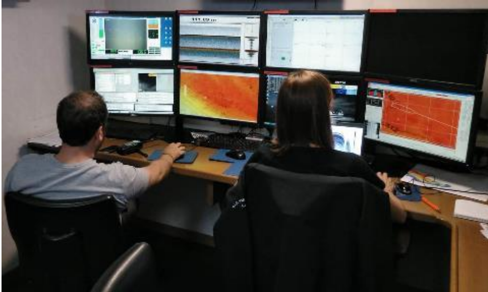
Figura 3.2.2.1.4. Vista de la disposición de las pantallas de los diferentes programas utilizados para la adquisición de datos geofísicos, en el laboratorio de acústica del B/O Ramón Margalef.
