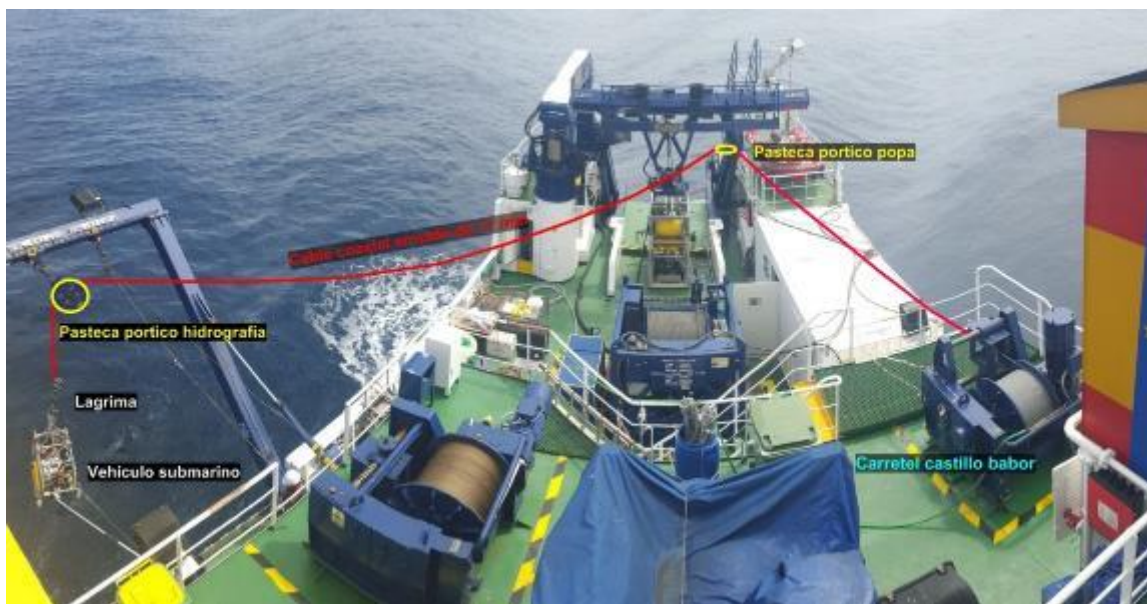
Figura 3.2.5.3. Despliegue del coaxial armado de 11mm hacia el pórtico de hidrografía mediante dos pastecas.
