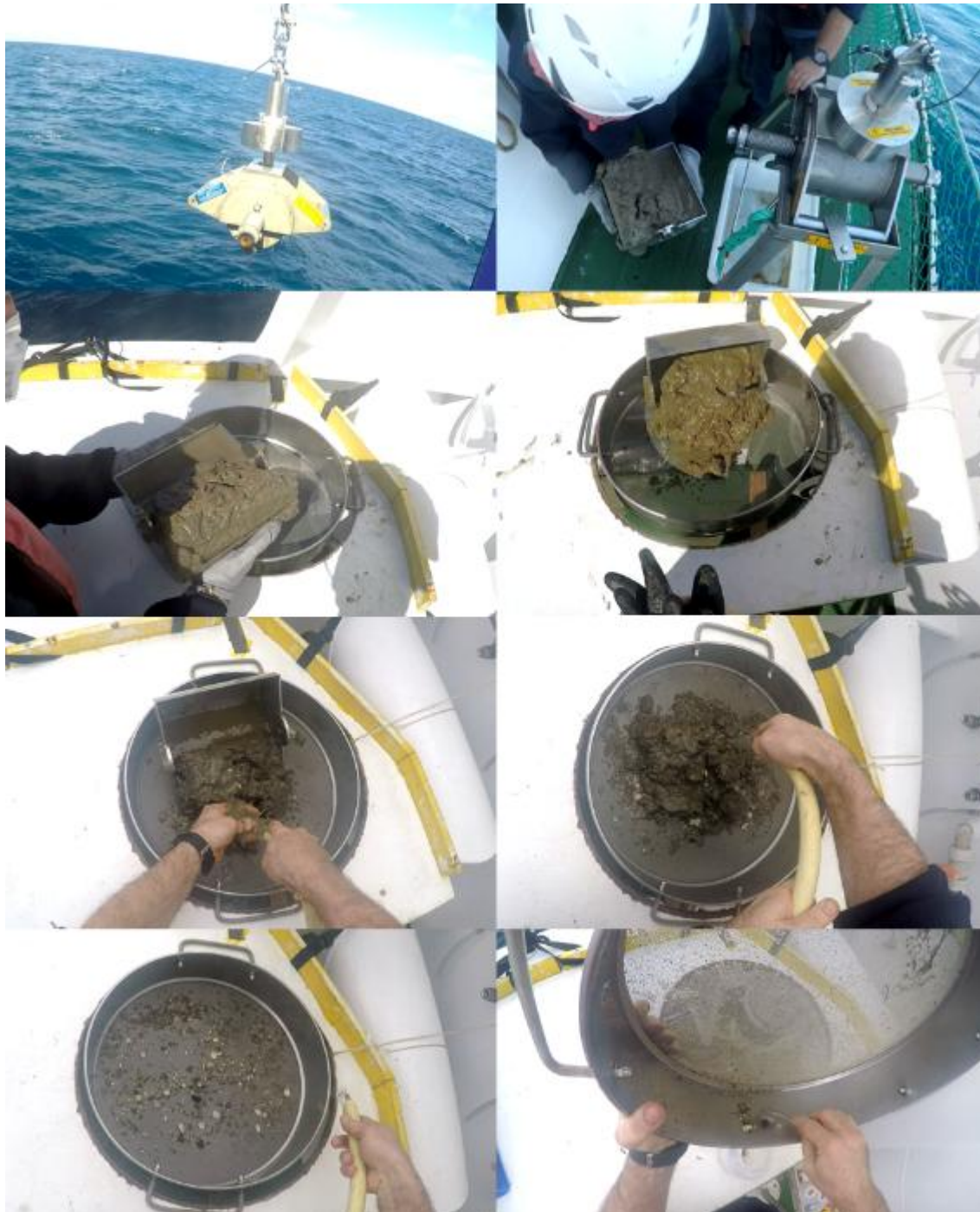
Figura 3.2.4.1.1. Secuencia de toma de muestra con draga Shipek : virado, extracción, lavado y tamizado de la muestra, y recogida de la fauna retenida.
