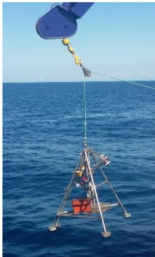
Figura 3.2.2.1.3. Fondeo del Lander Geodia en uno de los puntos seleccionados de la zona de estudio.
