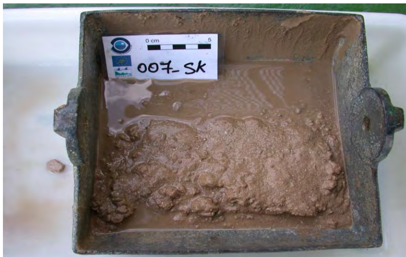
Figura 5. Muestra de sedimento recuperada con draga Shipek y correspondiente al punto de muestreo 007_SK.
