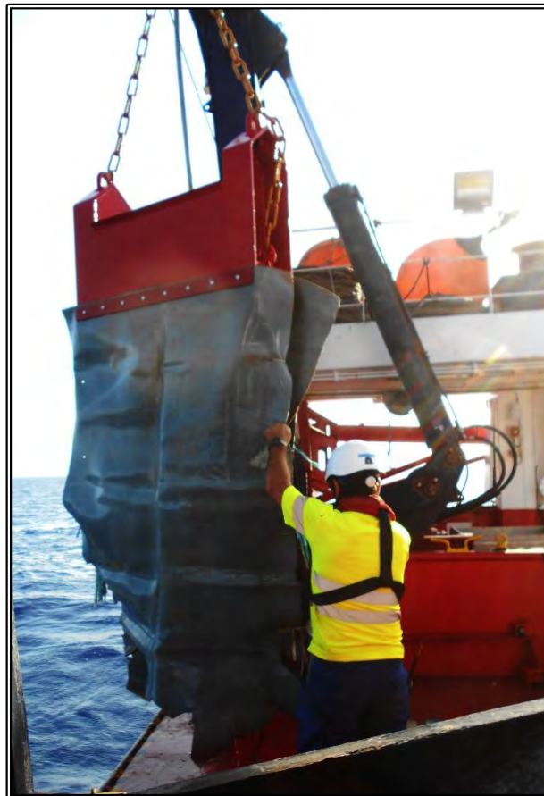
Figura 10. Muestreador draga de roca utilizado durante la campaña.
