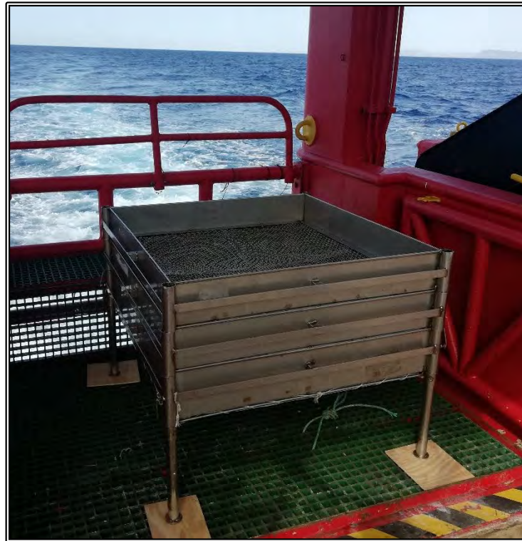
Figura 15. Torre de tamizado con tres tamices desde la zona superior a la inferior de mayor a menor diámetro de luz de malla: 10 mm, 5 mm y 1 mm,.
