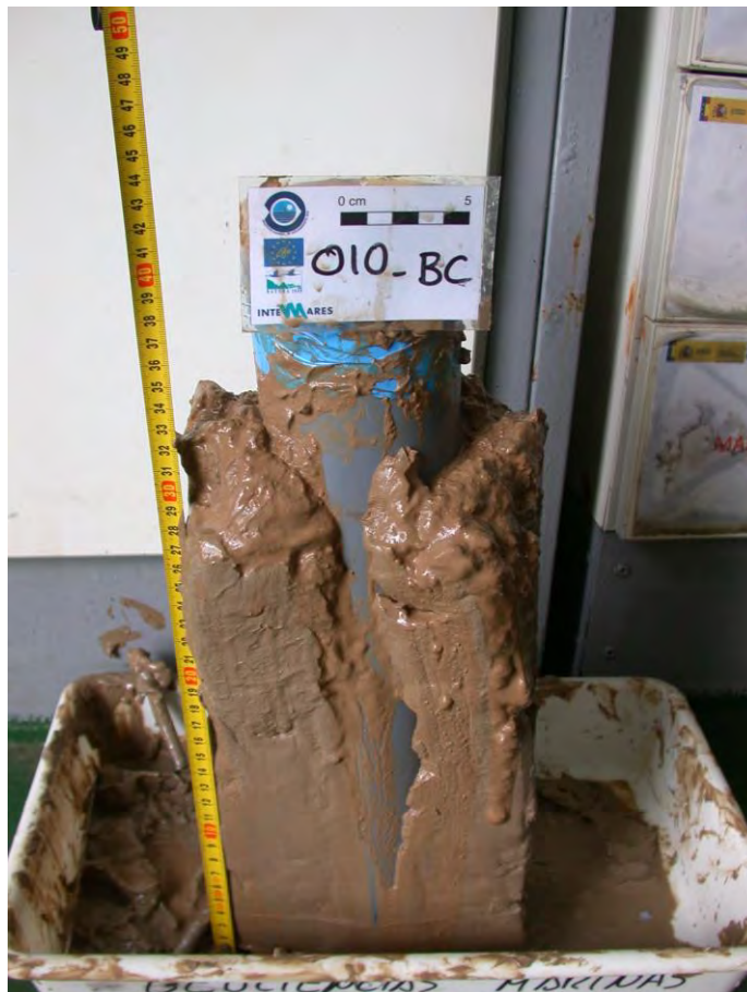
Figura 6. Box-corer 010_BC donde se observa cómo el sedimento fangoso se hace más compacto y menos saturado en agua hacia el muro o bottom.
