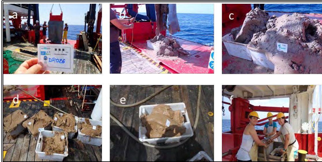
Figura 14. Diferentes fases del procesado de la muestra con las etiquetas correspondientes. a) izada del muestreador; b y c) disposición de la muestra en cajas; d) imagen general de todas las cajas correspondientes a una muestra; e) imagen de caja correspondiente a una submuestra; f) fase de dilución del sedimento compacto para un tamizado más eficiente.
