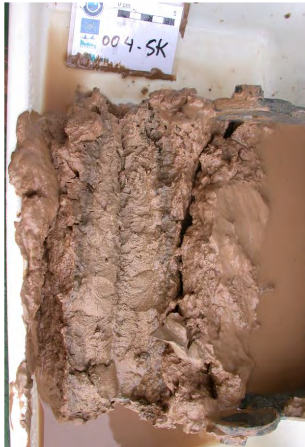
Figura 7. Sedimento recuperado en el punto de muestreo 004_SK donde se observa una laminación de color oscuro y de tamaño centimétrico.
