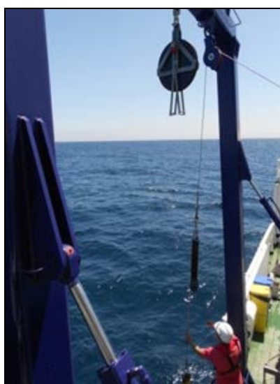
Figura 13. Maniobra de largada del perfilador de velocidad del sonido por la banda de estribor.
