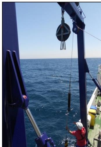
**Figura 2. Maniobra de largada del Perfilador de velocidad del sonido por la banda de estribor.**
