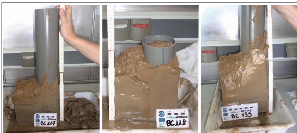
**Figura 17.** Muestras de Box Corer A22Mo118\_BC117, A22Mo118\_BC118 y A22Mo118\_BC135 en el momento del muestreo mediante un tubo de PVC de forma que se obtiene un registro continuo de su estructura sedimentaria.
